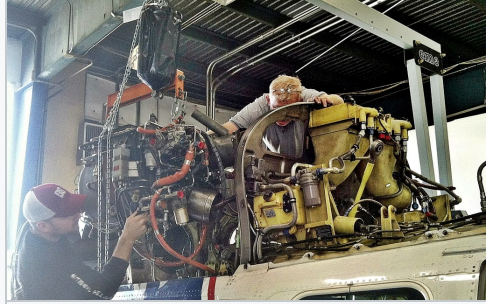
GÁLIBO EXTRACCIÓN DE MOTOR
